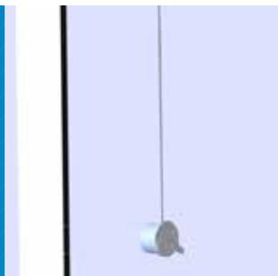
Ce système permet d'actionner le câble en acier pour ouvrir les loquets d'ouverture en aidant à diriger les vantaux vers le côté où ils se replient. Il est possible d'utiliser la poignée depuis l'intérieur, l'extérieur ou les deux à la fois.
