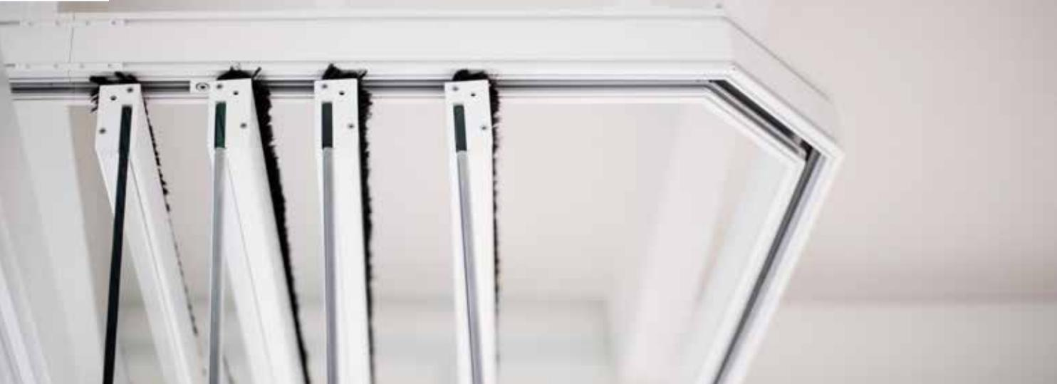
**Jusqu'à 4 mètres de hauteur, 1140 mm de largeur par vantail et tous types de verre : trempé, feuilleté, contrôle solaire et toute composition qui atteint 10 ou 12 mm d'épaisseur. De plus, le système dispose d'une « zone de parking » en bout de structure qui permet de stocker les panneaux efficacement.**
